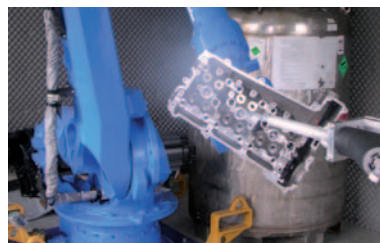
Der IceMaster arbeitet auch erfolgreich in der Entgratung von Aluminiumteilen.
